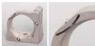
弹片和顶丝双重装卡镜片方式
